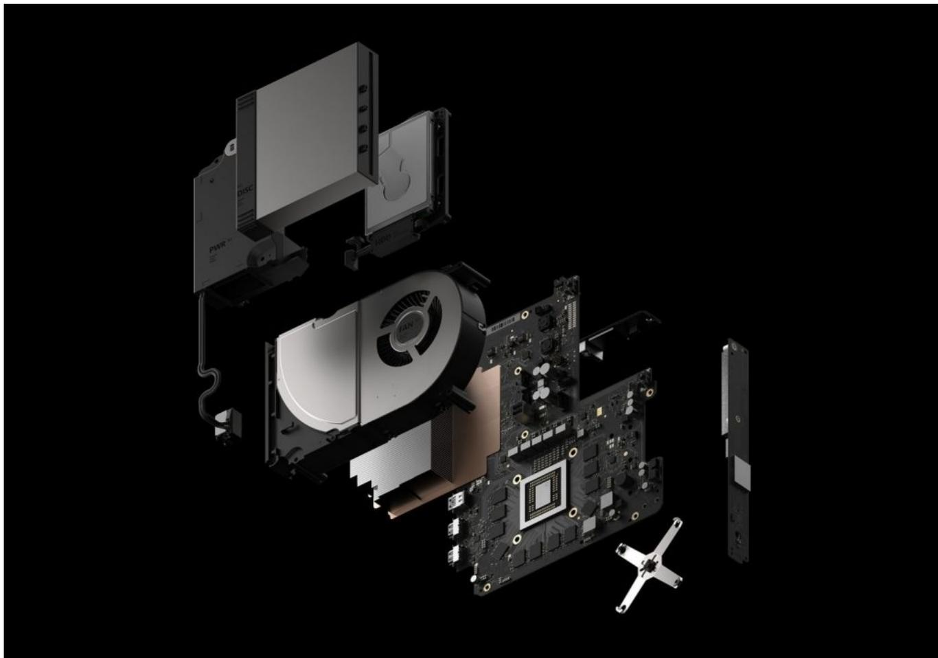
Quelle della CPU e GPU sono frequenze di funzionamento veramente alte per una console e per questo la **Microsoft** ha accompagnato l'intero **Scorpio Engine SOC** (system on chip) con un sistema di raffreddamento a camera di vapore, tipologia di dissipatori che di solito troviamo in prodotti high-end come le **GPU NVIDIA Founder's Edition GTX 1080** o la top di gamma **GTX 1080ti**.
