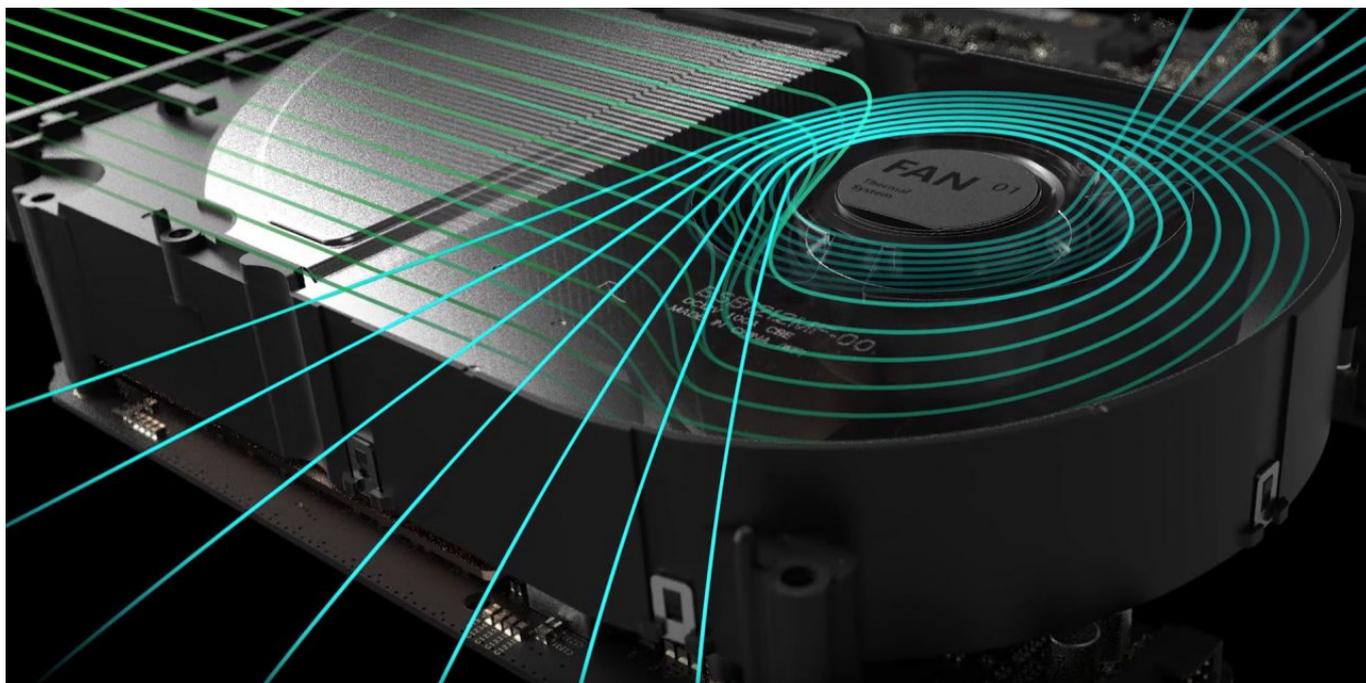
Microsoft sta infine usando un dissipatore - costituito da un recipiente di rame che ne costituisce la base - all'interno del quale viene ionizzata acqua distillata sotto vuoto: il calore viene assorbito dall'acqua, la quale si vaporizza, e il vapore viene portato lontano dalle zone calde per condensarsi infine sulle alette del dissipatore. Questa soluzione è considerata rivoluzionaria per una console, ed è uno dei tecnicismi più interessanti fra quelli esposti oggi.
